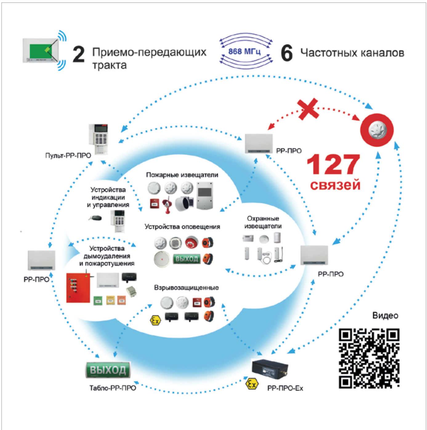
Рис. 1. Резервирование линий связи в «Стрельце-ПРО»
