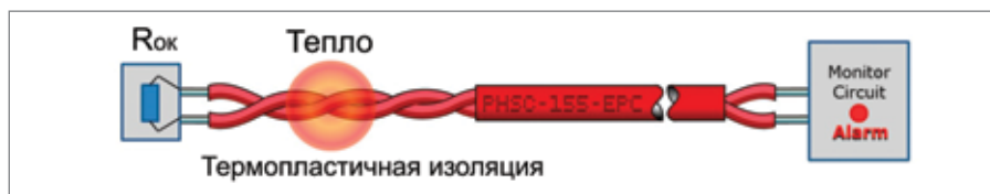
Рис. 5. Термокабель в режиме пожар
