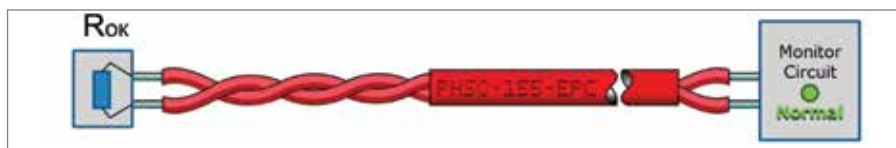
Рис. 4. Термокабель в дежурном режиме
