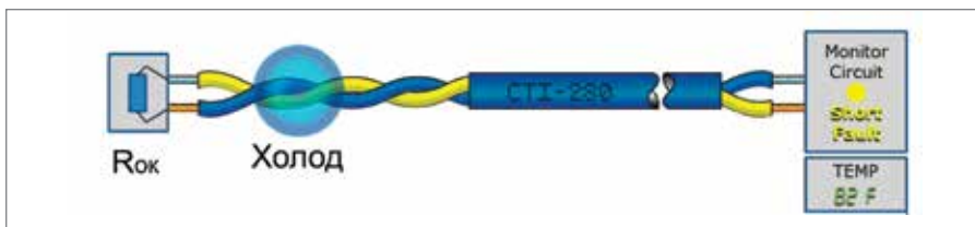
Рис. 10. Термокабель СТІ в режиме «Короткое замыкание»
