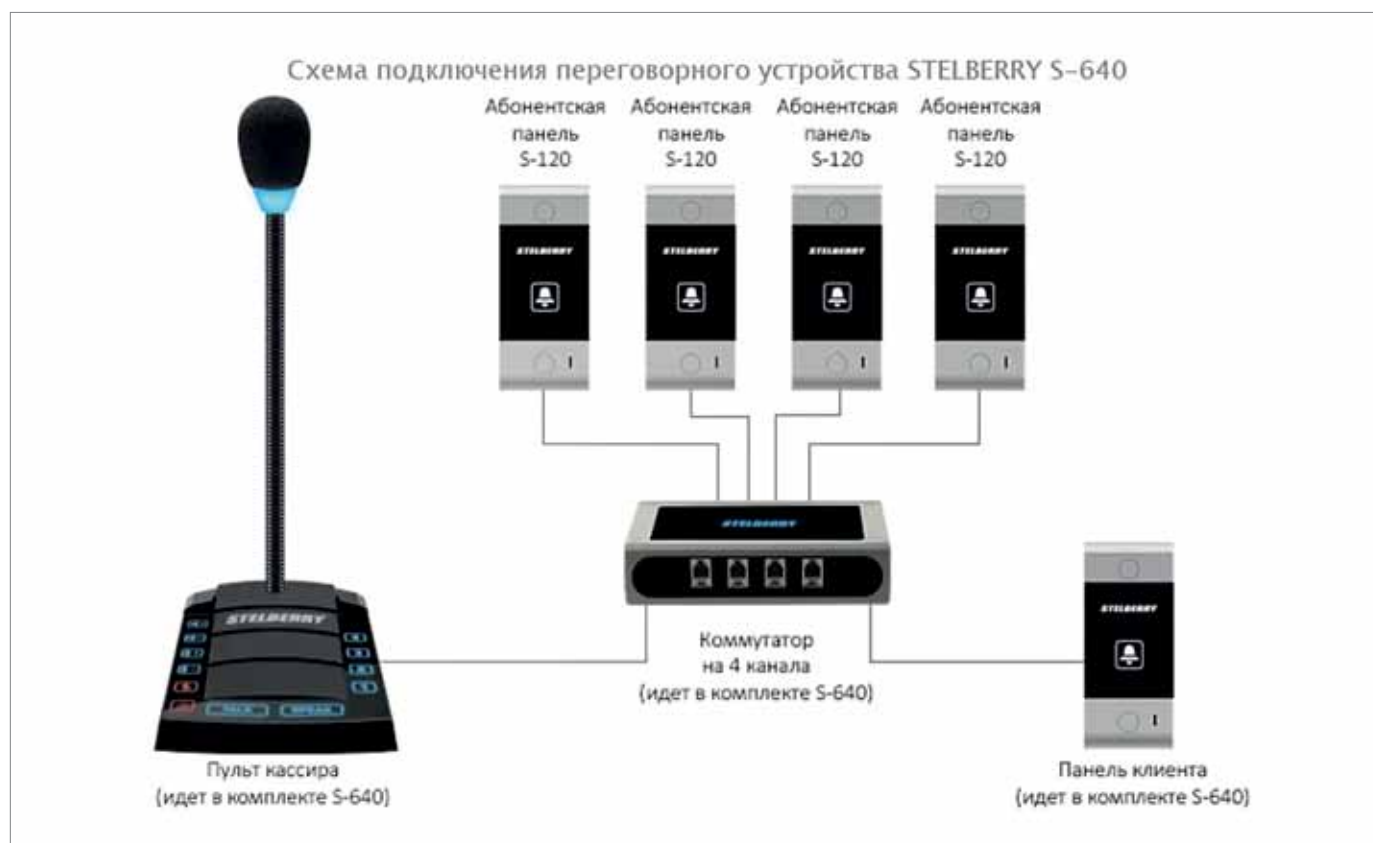
Фото 12. Схема подключения переговорного устройства STELBERRY S-640
