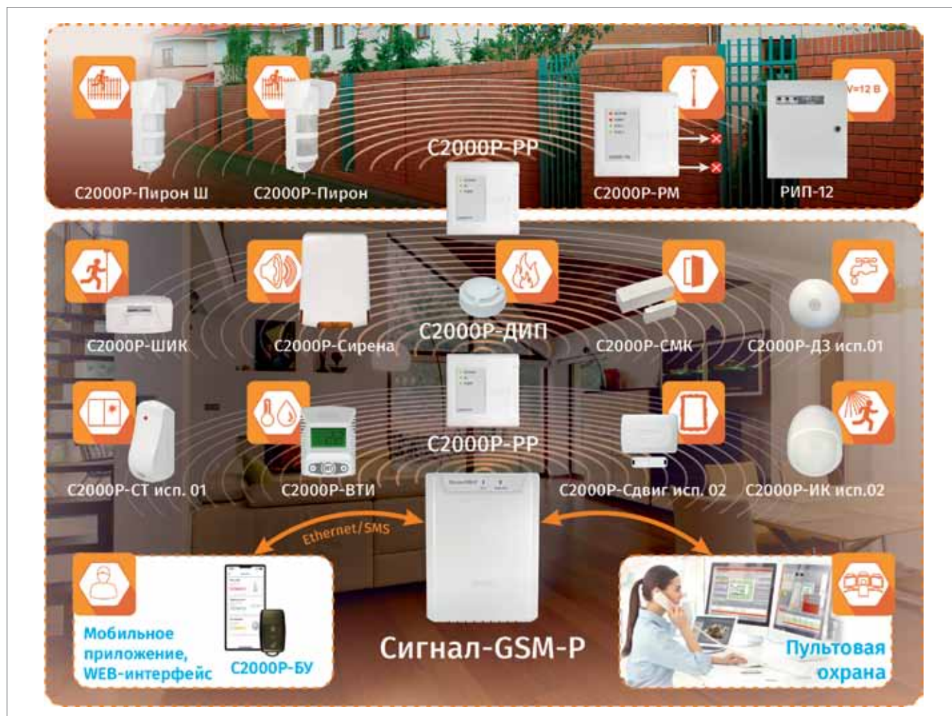
Рис. 1. Состав и архитектура системы «Антарес»
