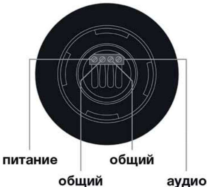
Сзади микрофона STELBERRY M-210HD расположены винтовые колодки для коммутации.
