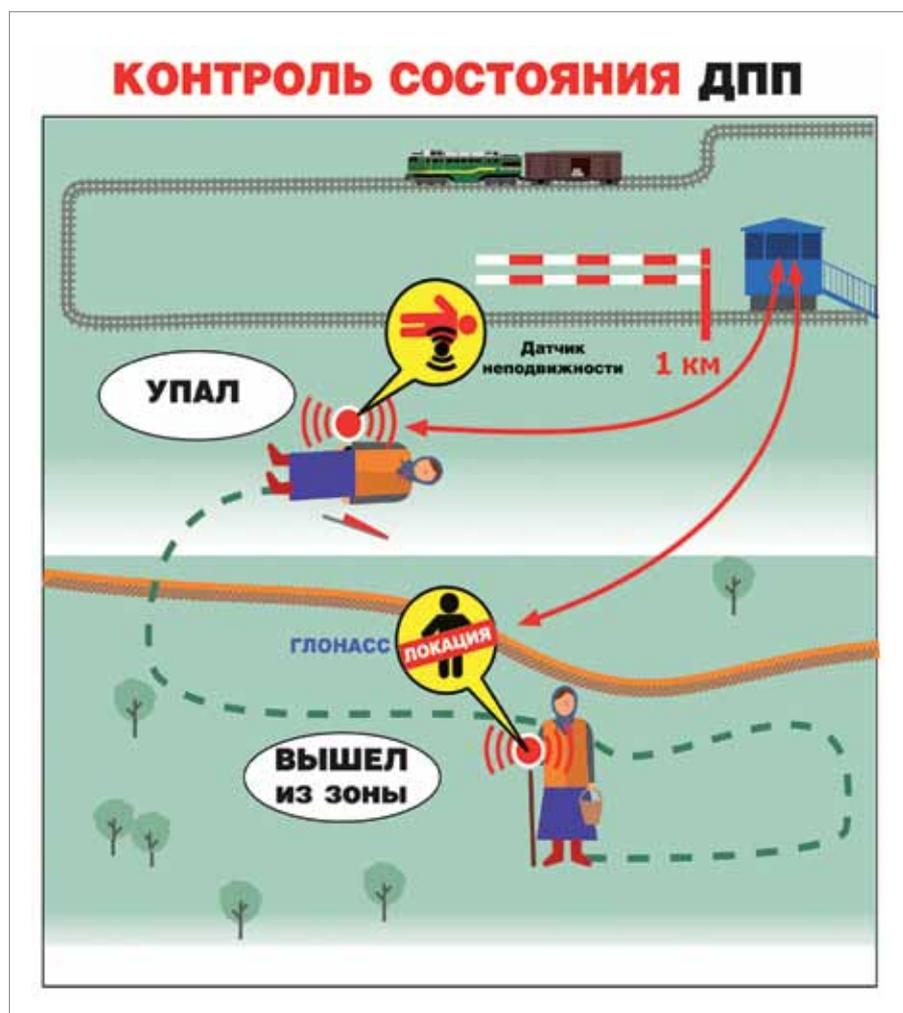
Рис. 1б. Управление светофором. Контроль состояния дежурного по переезду
