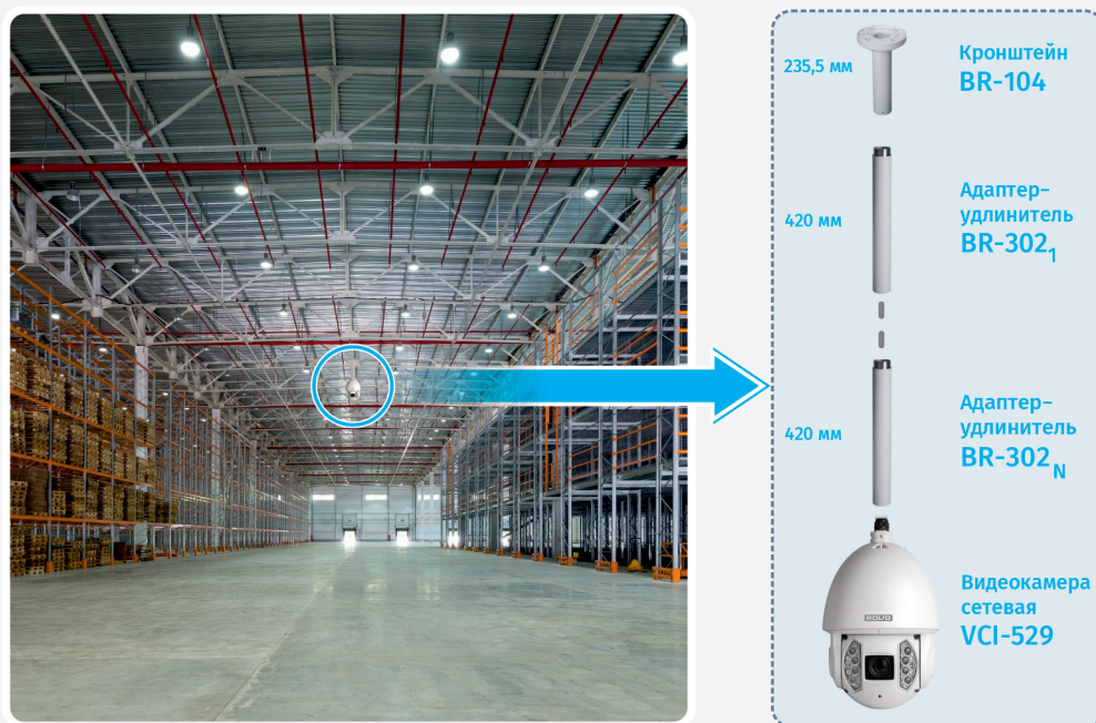
ПРИМЕР МОНТАЖА КАМЕРЫ НА ВЫСОКИЙ ПОТОЛОК
