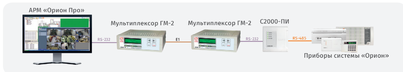
Рисунок 98. Структурная схема использования мультиплексора «ГМ-2» с АРМ «Орион»/«Орион Про»
