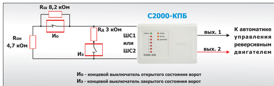
Рис.4. Управление воротами с помощью С2000-КПБ
