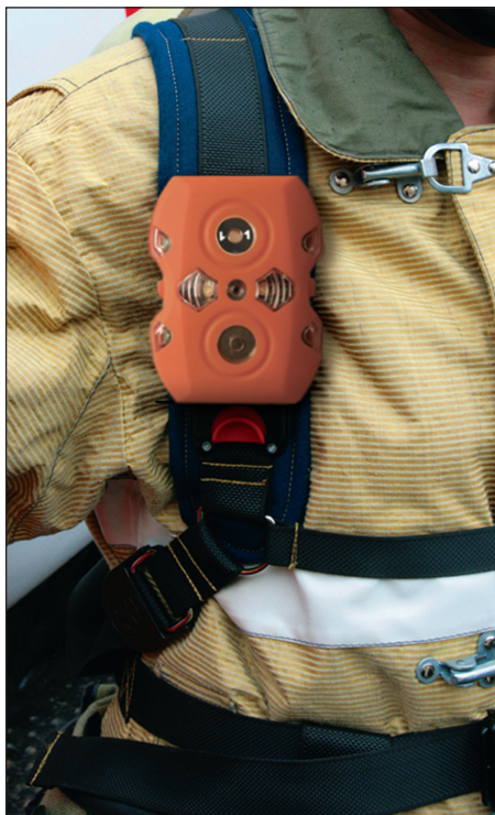
Рис. 1. Радиоустройство для обнаружения пожарных и экстренного оповещения об эвакуации
