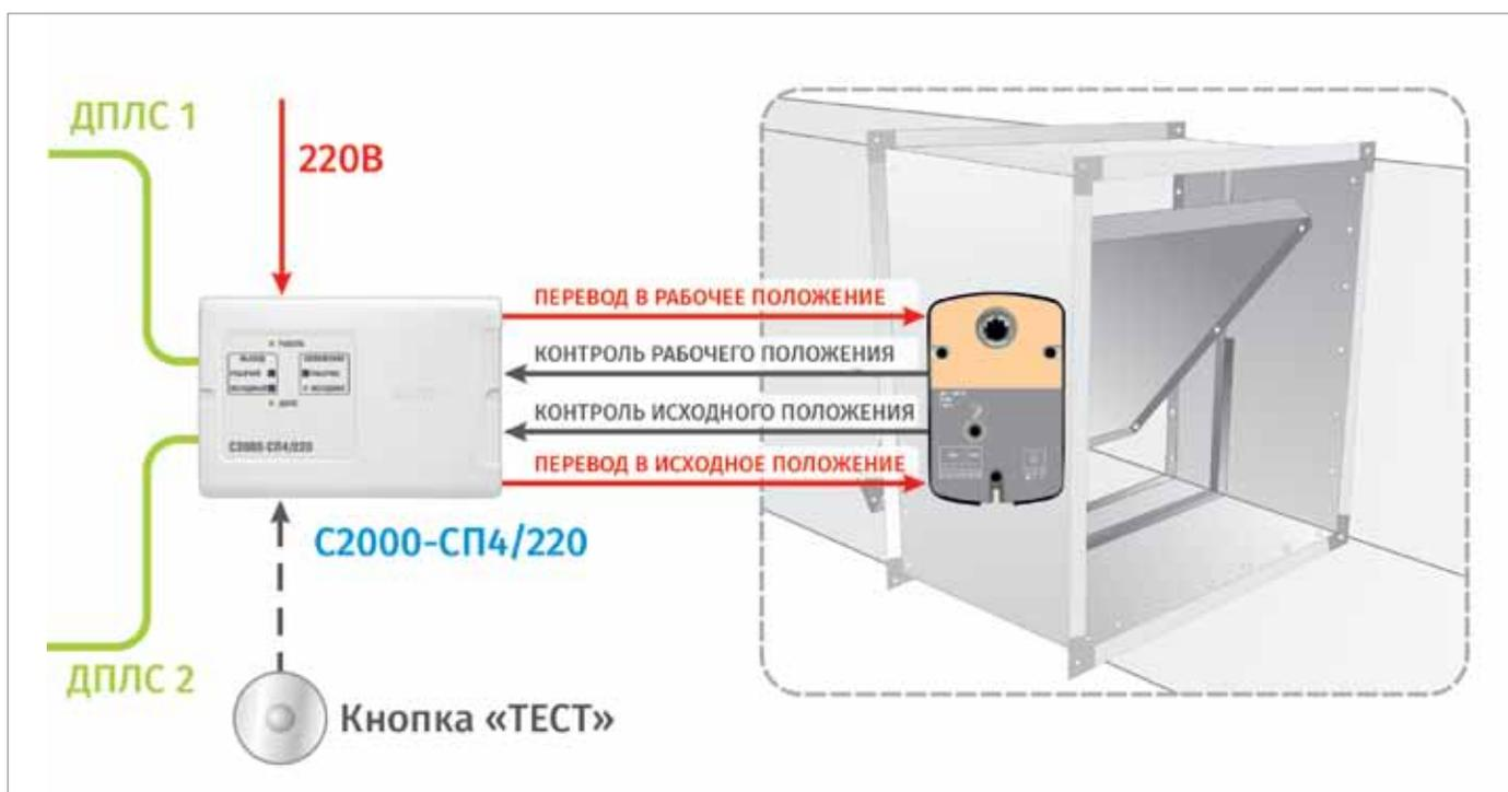
Рис. 1. Схема включения неадресного привода
