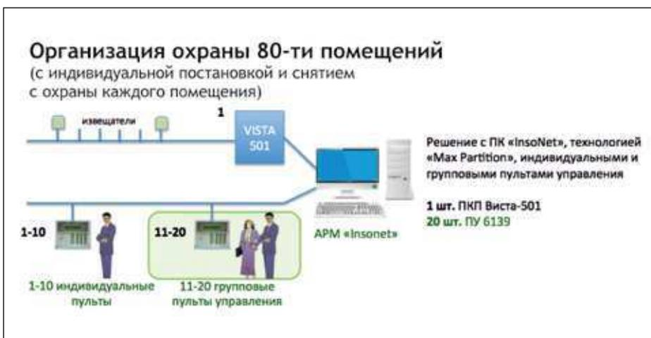
Рис. 3. Структура построения объекта с охраной до 80-ти помещений
