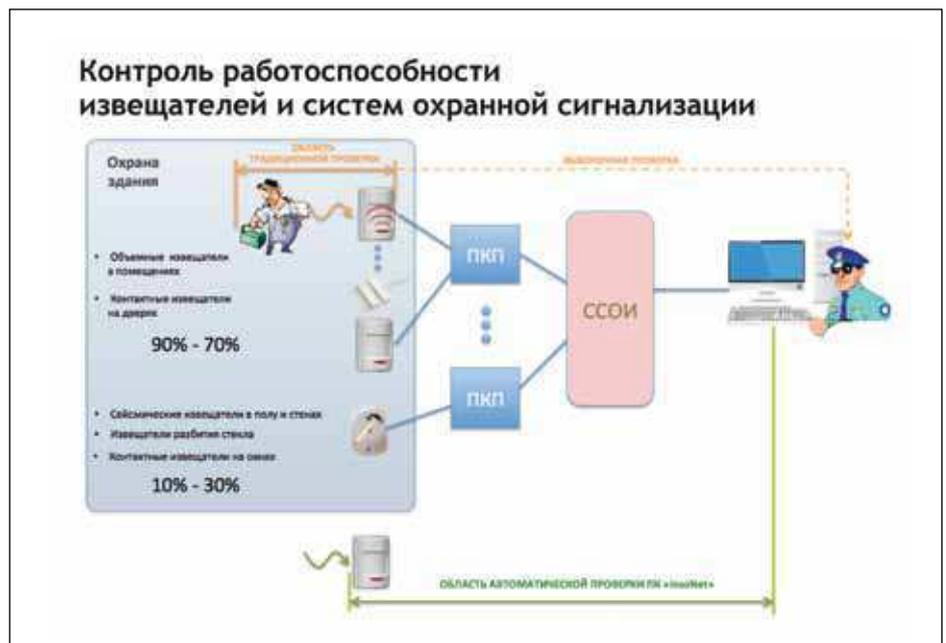
Рис. 5. Контроль извещателей и охранной сигнализации
