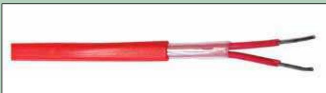
Линейный тепловой извещатель (термокабель) представляет собой кабель, который предназначен для обнаружения возгораний по значению температуры окружающей среды в любом месте на всем его протяжении. Термокабель представляет собой датчик непрерывного действия и применяется в тех случаях, когда условия не позволяют установку и использование тепловых точечных извещателей, а в условиях повышенной взрывоопасности применение термокабеля является оптимальным решением.
