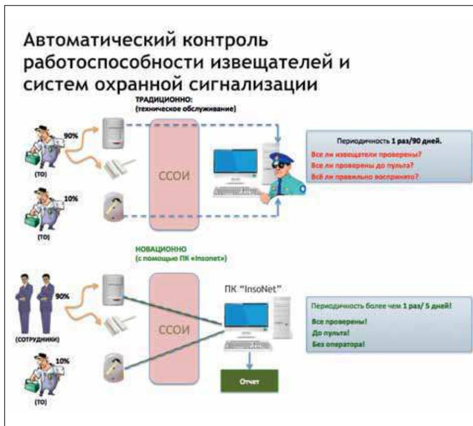
Рис. 6. Автоматическая проверка извещателей и охранной сигнализации
