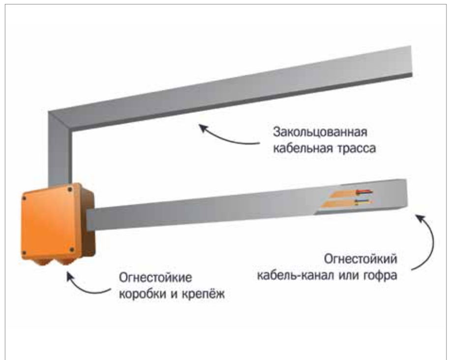
Рис. 2. Монтаж кабельных линий в соответствии с нормами
