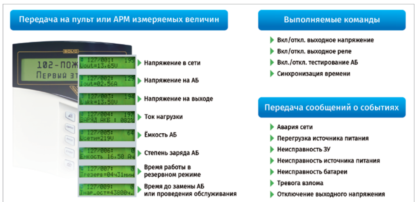
Рис. 1. С2000М: команды управления, взаимодействуя с приборами контроля
