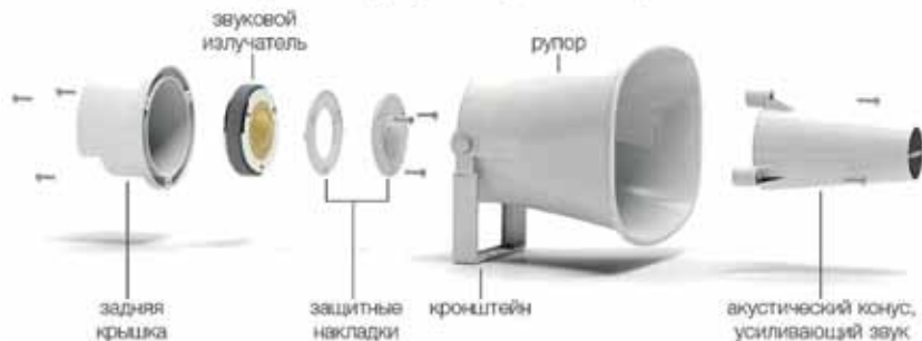
Устройство рупорного громкоговорителя
