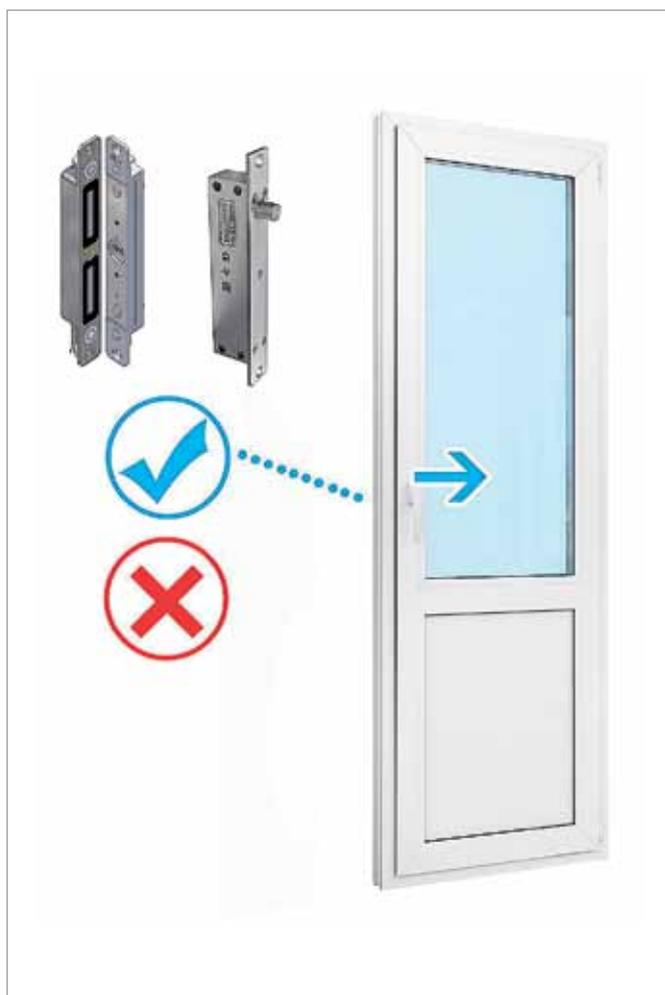
Рис. 2. Установка замка около ручки двери
