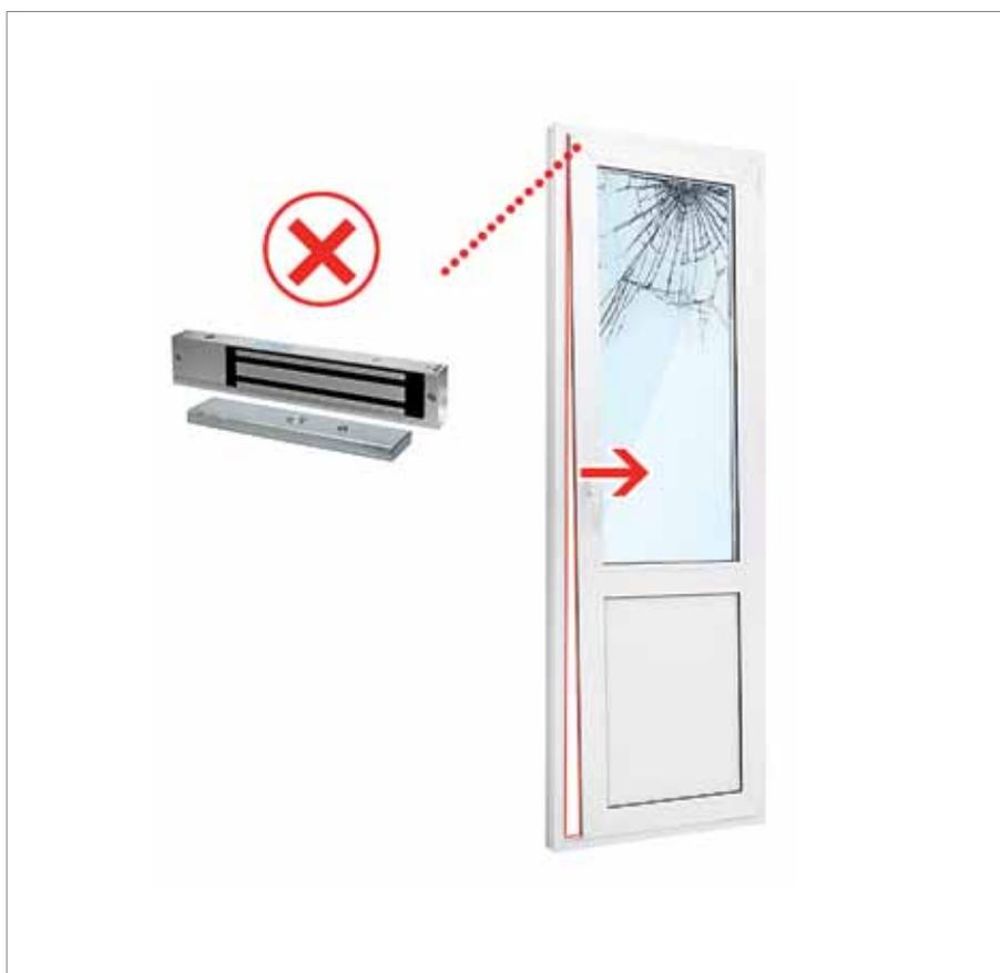
Рис. 1. Установка замка на верхнюю часть двери
