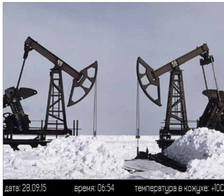
Фото 3. Отображение температуры внутри кожуха на картинке с видеокamеры
