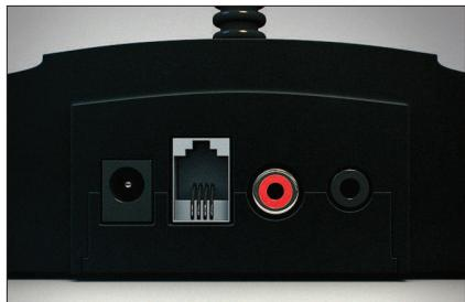
Рис. 3 Четыре разъема на пульте кассира – для реализации всех функций
