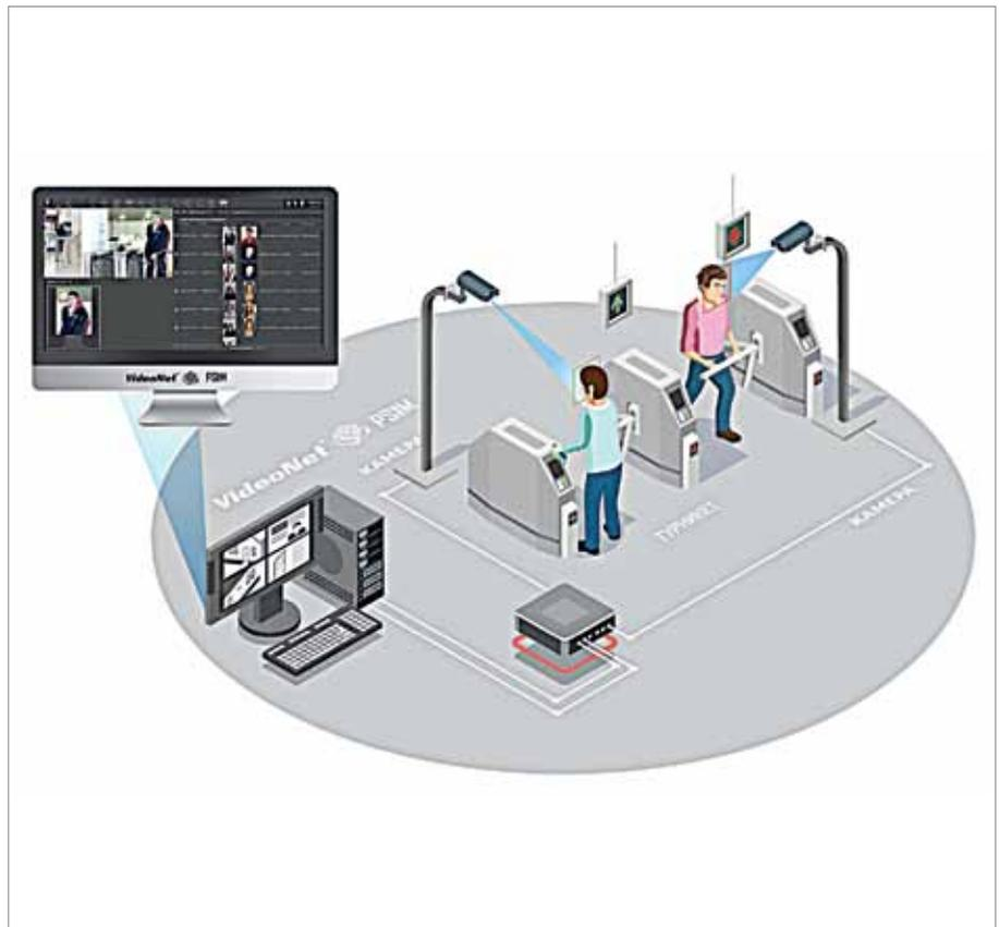
Рис. 6. Система контроля доступа с многофакторной идентификацией.
