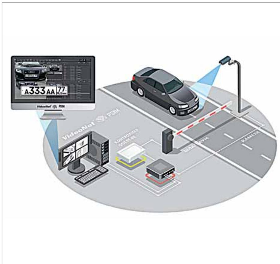
Рис. 4. Система контроля доступа с распознаванием номеров автомобилей.
