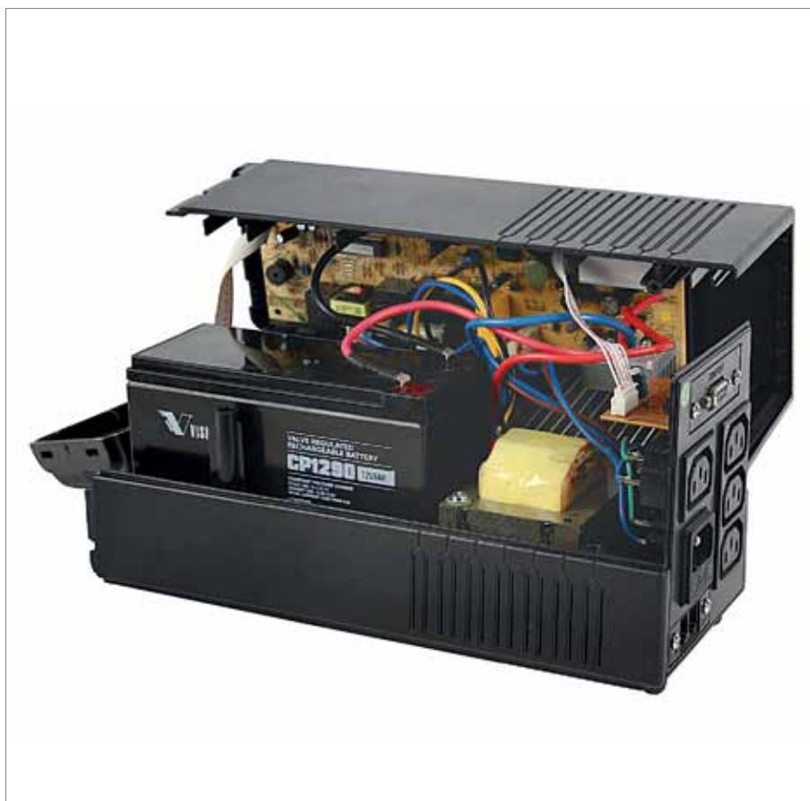
Фото 3. Специализация аккумуляторов VISION - источники бесперебойного питания
