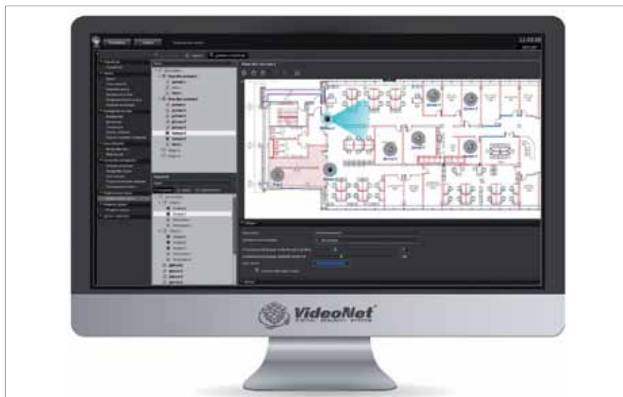
Рис. 1. Оператор может управлять устройствами ОПС непосредственно на графическом плане объекта
