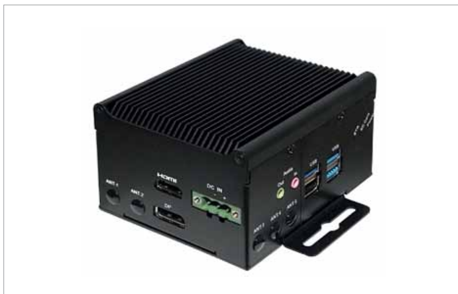
Рис. 3. EverFocus eNVP-JNN-AI-UB000 с модулем NVIDIA Jetson Nano
