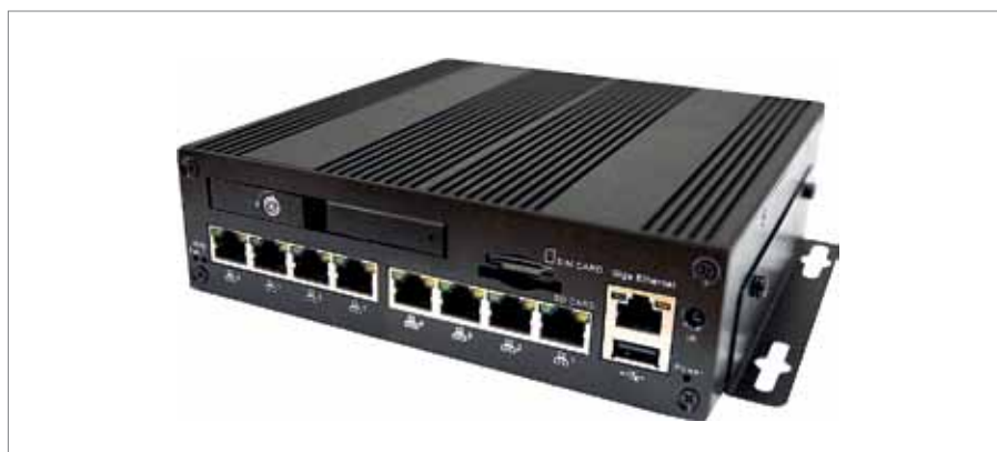
Рис. 4. EverFocus eIVP1570 VE с модулем Jetson Xavier NX
