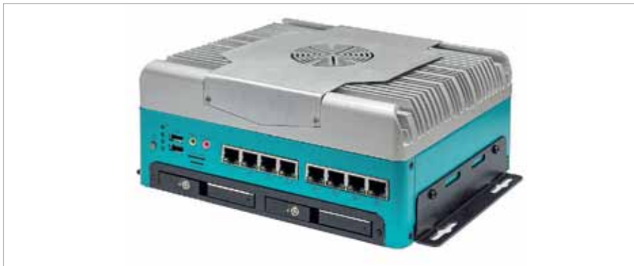
Рис. 5. EverFocus eNVP-JAO-AI-V0008 с модулем NVIDIA Jetson Orin NX
