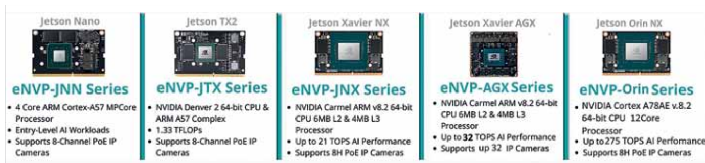
Рис. 1. Модельный ряд системных процессорных модулей NVIDIA Jetson
