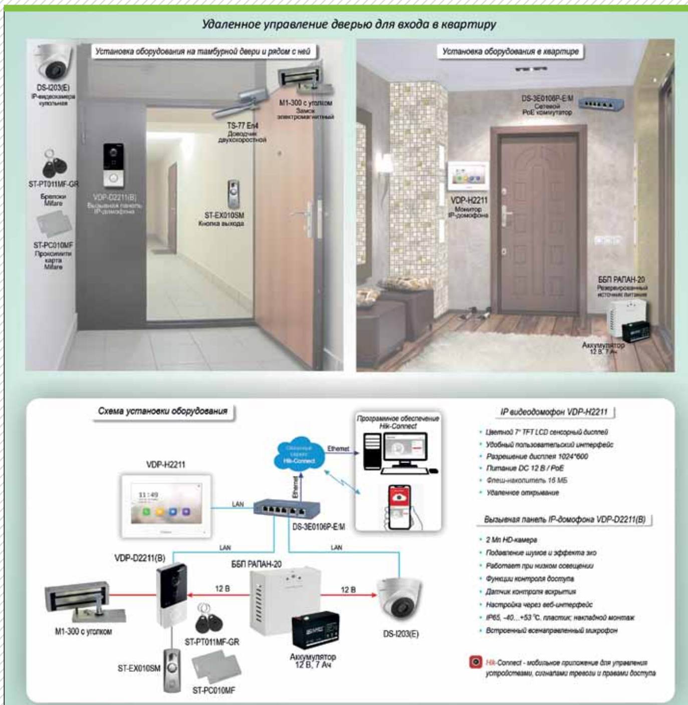
Рис. 3. Схема построения системы ограничения доступа в тамбурные помещения многоэтажного дома
