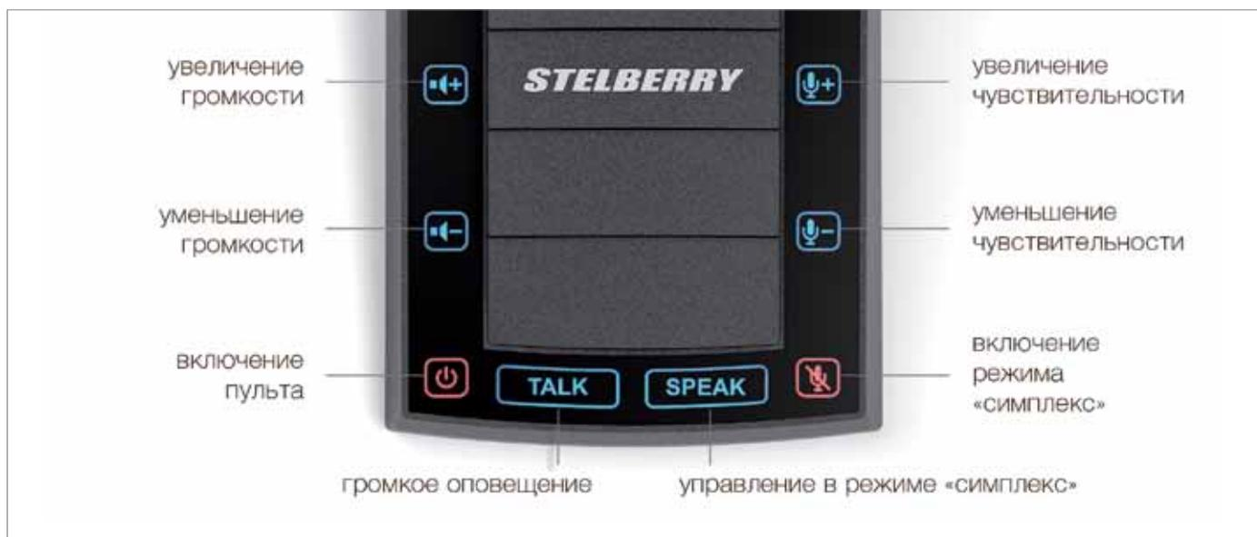
Регулировки громкости и чувствительности позволяют быстро настроить громкость пульта и чувствительность микрофонной стойки до комфортного уровня.
