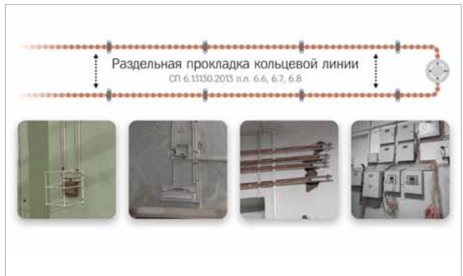
Рис. 2. Раздельная прокладка кольцевой линии
