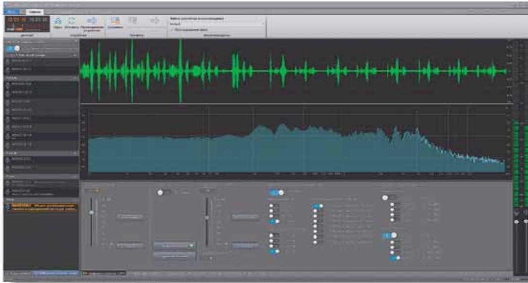
Вкладка регулировки усиления и выходной автоматической регулировки уровня (АРУ) позволяет вручную отрегулировать уровень сигнала или включить выходную систему АРУ, которая будет поддерживать сигнал на заданном уровне.
