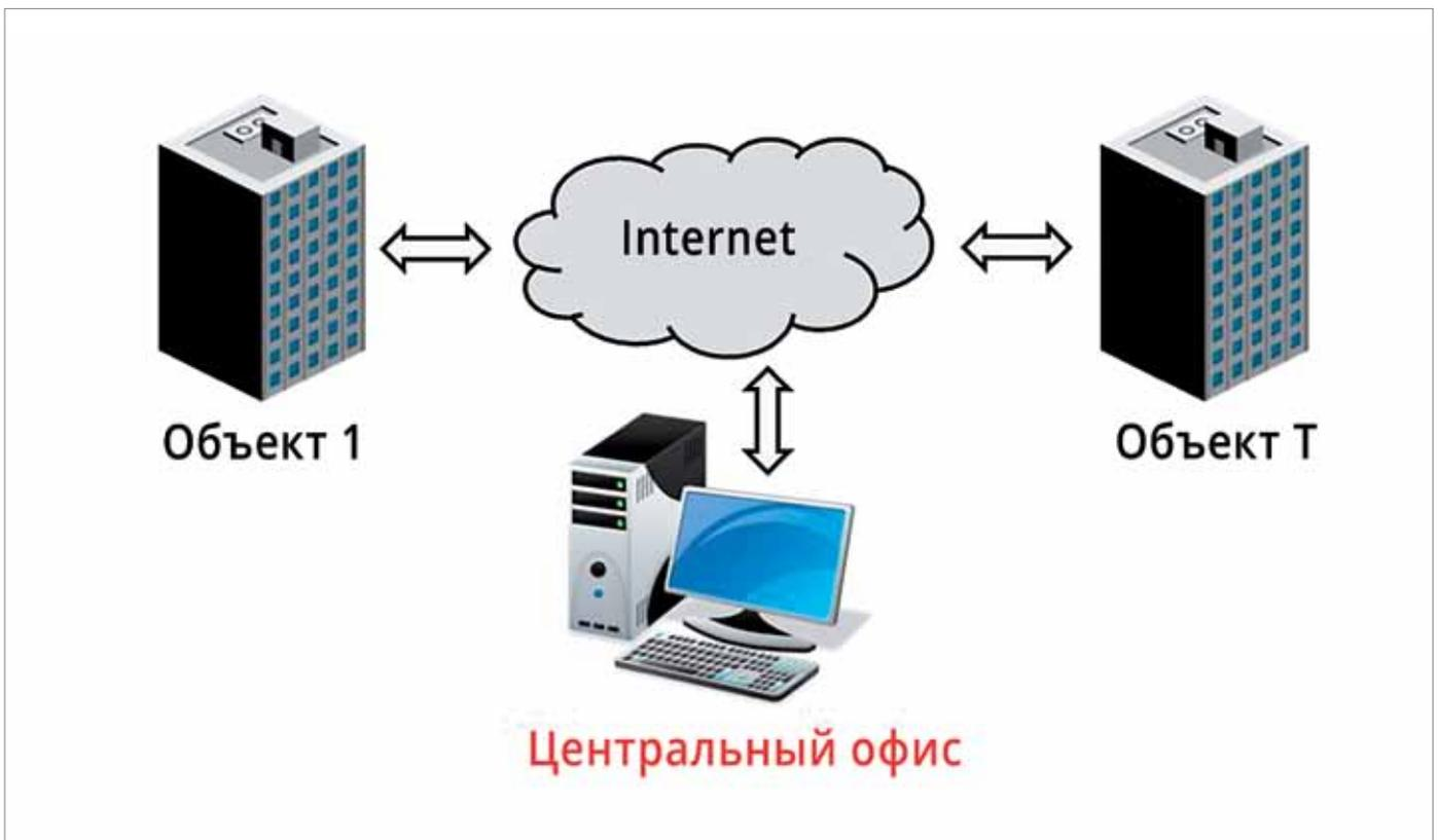
Рис. 7. Состояние систем пожарной сигнализации объектов, где бы они ни находились, можно контролировать из центрального офиса с помощью облачных технологий
