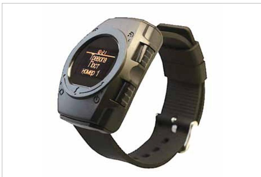
Рис. 5. Устройство «Браслет-ПРО» позволяет оперативно оповещать работников объекта и контролировать их местонахождение
