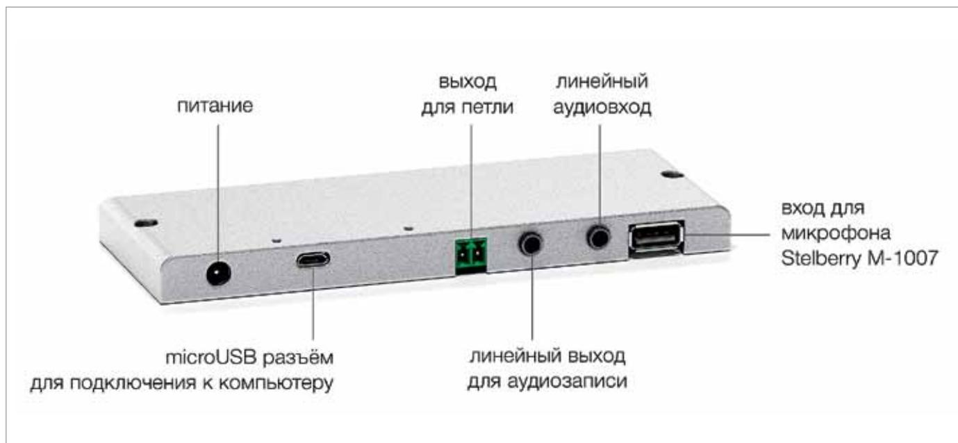
Разъём питания предназначен для подключения блока питания со стабилизированным выходным напряжением +12 В и выходным постоянным током до 2 А. Данный блок питания идёт в комплекте с усилителем индукционной петли S-350.
