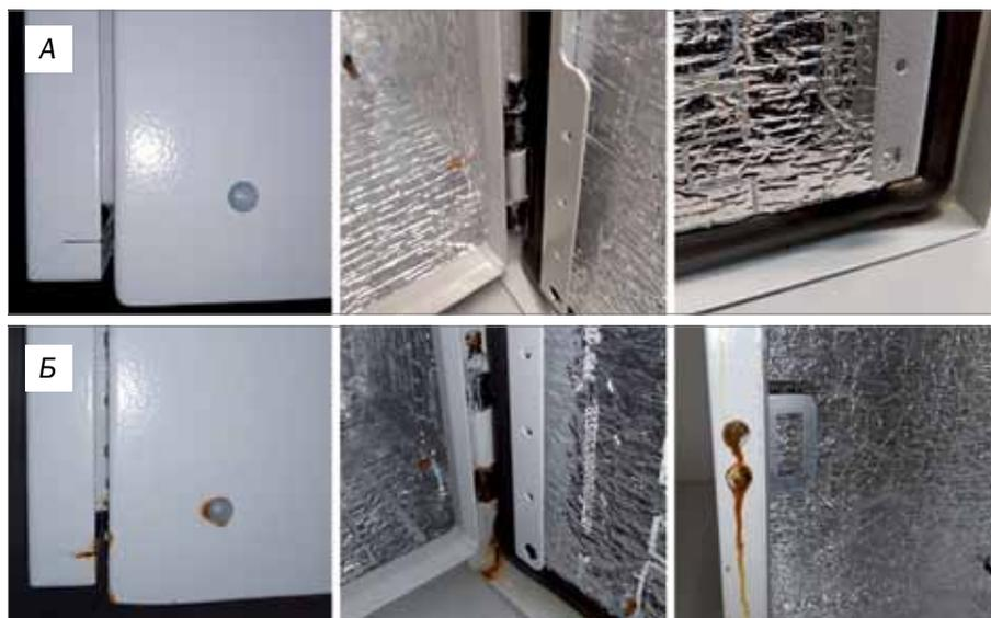
Рис. 5. Сравнительные испытания стойкости шкафов к воздействию соляного тумана: А – шкаф REMER с трёхслойным покрытием, Б – шкаф со стандартным покрытием
