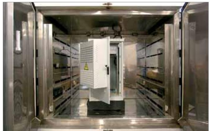
Рис. 7. Климатическая камера с установленным для испытаний шкафом ШТВ-1
