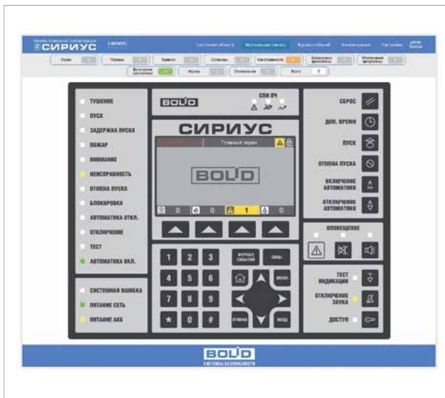
Рис. 1. Содержимое раздела «Виртуальная панель» web-интерфейса
