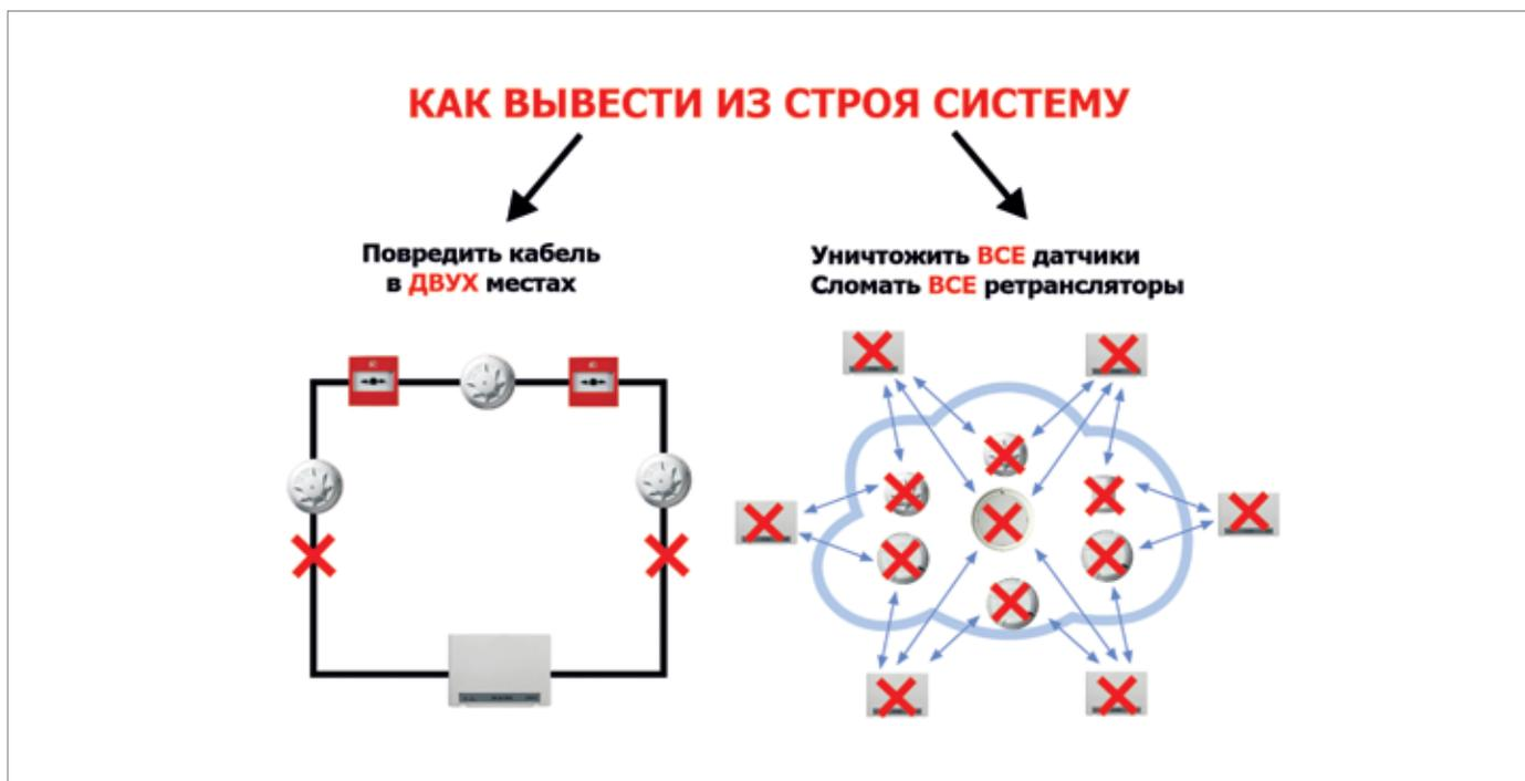
Рис. 3 Сравнение надежности проводной и беспроводной систем.
