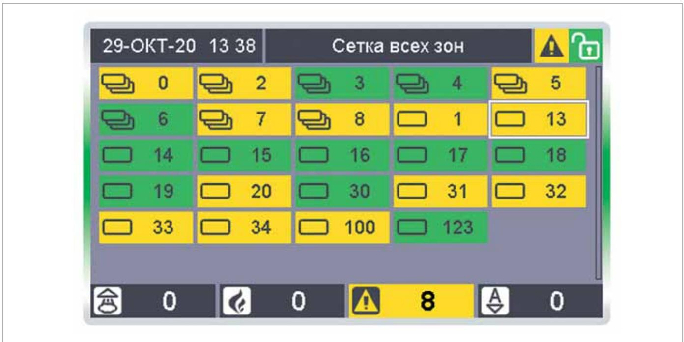
Рис. 4. Экран режима отображения всех зон системы в виде сетки
