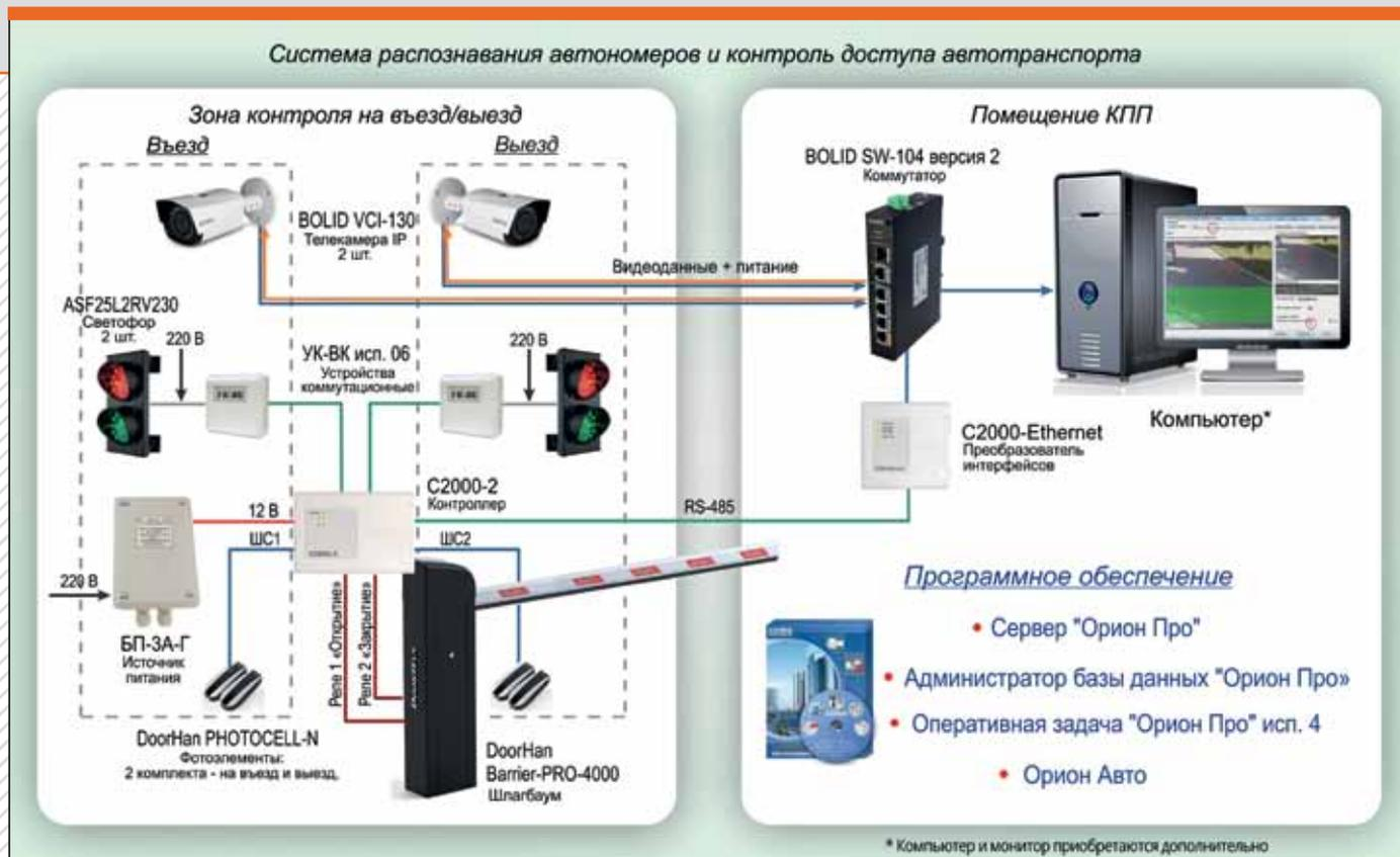
Рис. 2. Схема построения системы контроля доступа с автоматическим распознаванием автономеров при въезде (выезде) на охраняемую территорию
