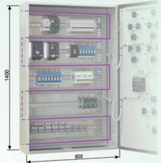
Вариант №4. Схема монтажа ФОГ Шнур 500 (6,3 м) в электрошкафах объемом до 500 литров
