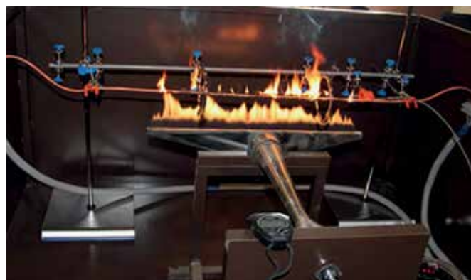
Рис. 4. Испытание кабеля на огнестойкость
