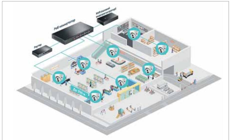
Рис. 3. Подача питания и данных – на расстоянии до 250 метров
