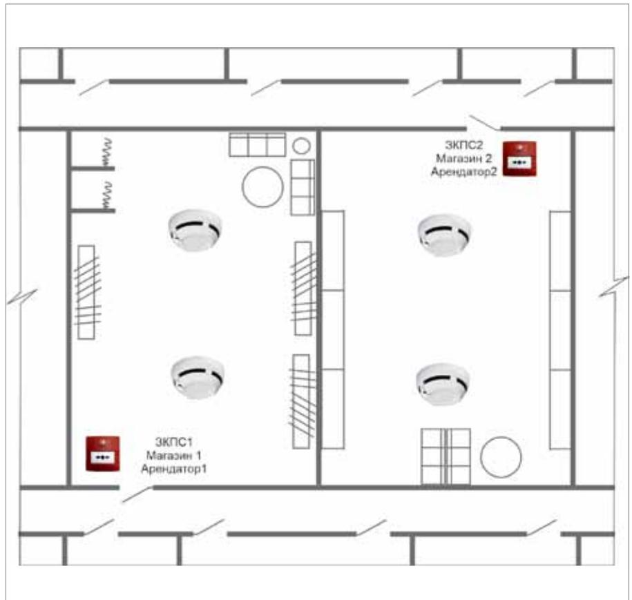
Рис. 2. План ТЦ. Размещение радиоизвещателей
