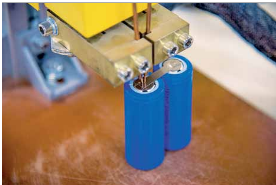
Рис. 2. Сварка аккумуляторной батареи из литий-ионных элементов
