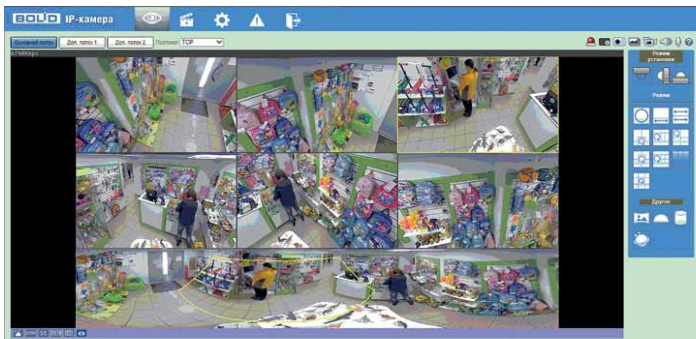
Рис. 5. Цифровая обработка изображения в видеокамере для получения панорамного изображения
