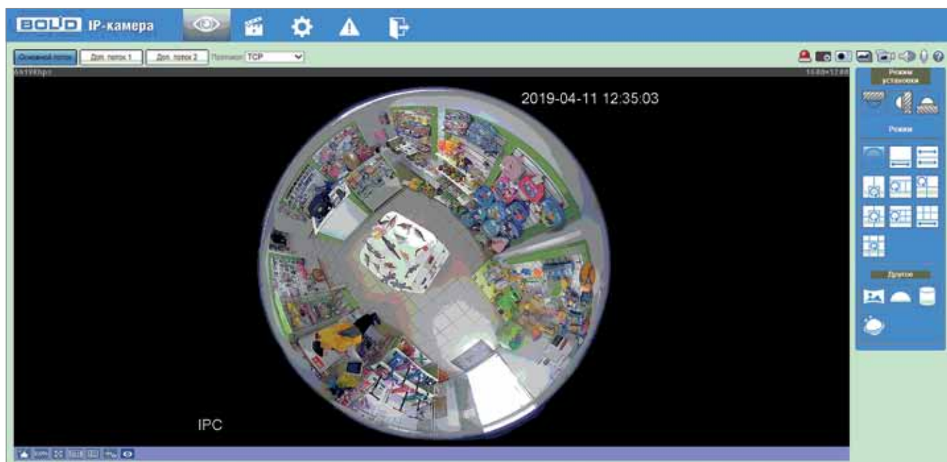
Рис. 3. Дисторсия объектива камеры FishEye
