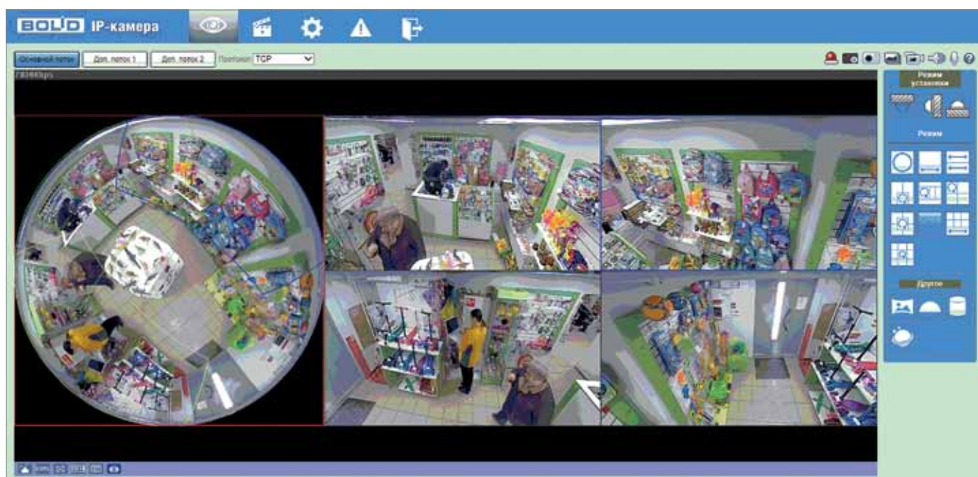
Рис. 4. Цифровая обработка изображения в видеокамере для получения прямоугольного кадра изображения
