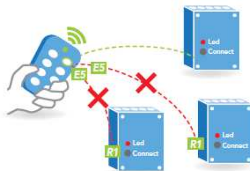
A-3b Отсоединение кнопки передатчика от 2-х приемников из 3-х
