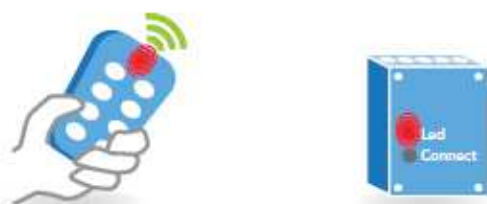
A-2a Светодиоды мигают, когда приемник получает команды от передатчика
