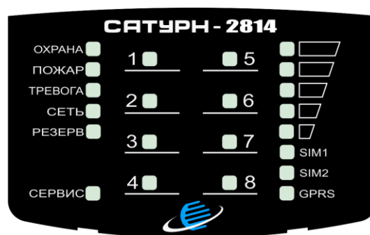
Рис.5. Внешний вид панели индикации «Сатурн-2814»
