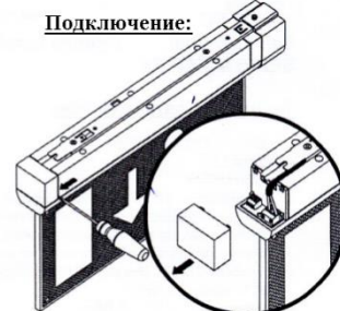
Рис. 2 - Схема подключения светильников для централизованных систем питания
