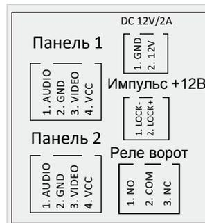
**Важный момент:** для стабильной работы подключите защитный диод параллельно контактам замка (Соблюдайте полярность при подключении!). Подходят диоды 1N5400, 1N5408, 1N5821, HER301 и аналогичные.
