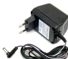
Во избежание перегрева и последующего **необратимого** срабатывания термопредохранителя, необходимо обеспечить свободный приток воздуха к блоку питания.
