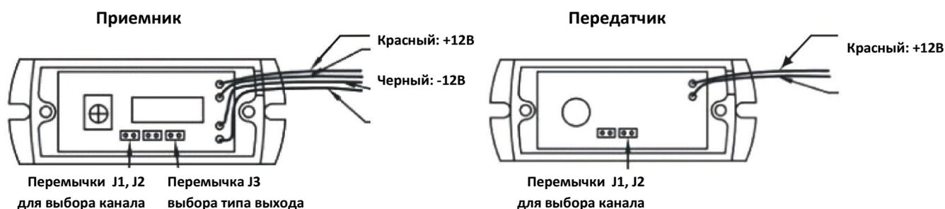
Переключатели J1 и J2 используются для установки одного из 4-х каналов, данные переключатели должны быть установлены одинаково для приемника и передатчика. Переключатель J3 используется для установки типа выхода. Установите данную переключатель, если требуется НЗ выход, а если требуется НР, уберите переключатель.
