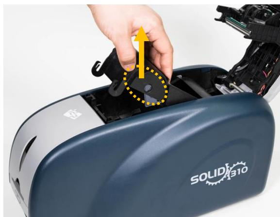
*Рис. 9 Вытащите съемный картридж с лентой*
