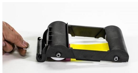
*Рис. 13 Удаление защитной пленки*
