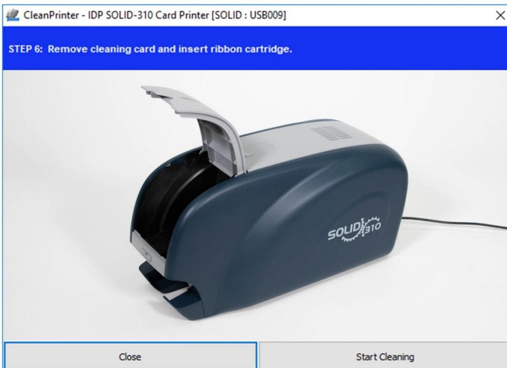
*Рис. 93 Очистка Принтера Шаг 6*
