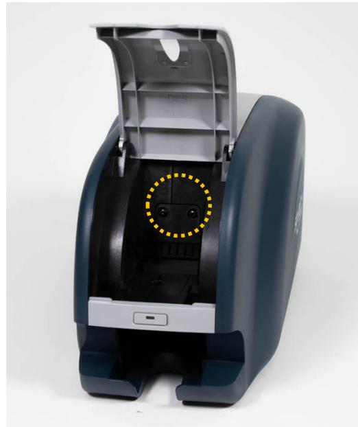
Рис. 16 Модуль настройки толщины карт
