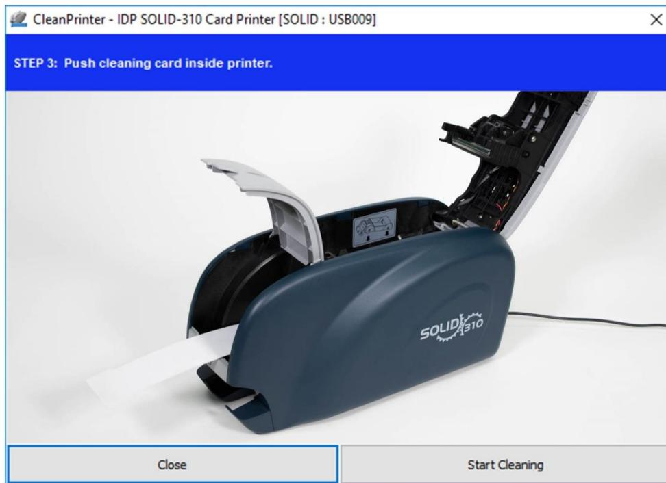
*Рис. 90 Очистка Принтера Шаг 3*
