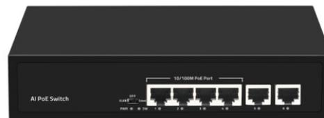
Неуправляемый коммутатор ST-NS004MB-MD предназначен для передачи данных между сетевыми устройствами, а также питания этих устройств. PoE (Power over Ethernet) – технология, позволяющая передавать удалённому устройству электрическую энергию вместе с данными через стандартную витую пару в сети Ethernet. Данная технология предназначена для IP-телефонии, IP-камер, сетевых концентраторов и других устройств, к которым нежелательно или невозможно подведение отдельного электрического кабеля питания.
