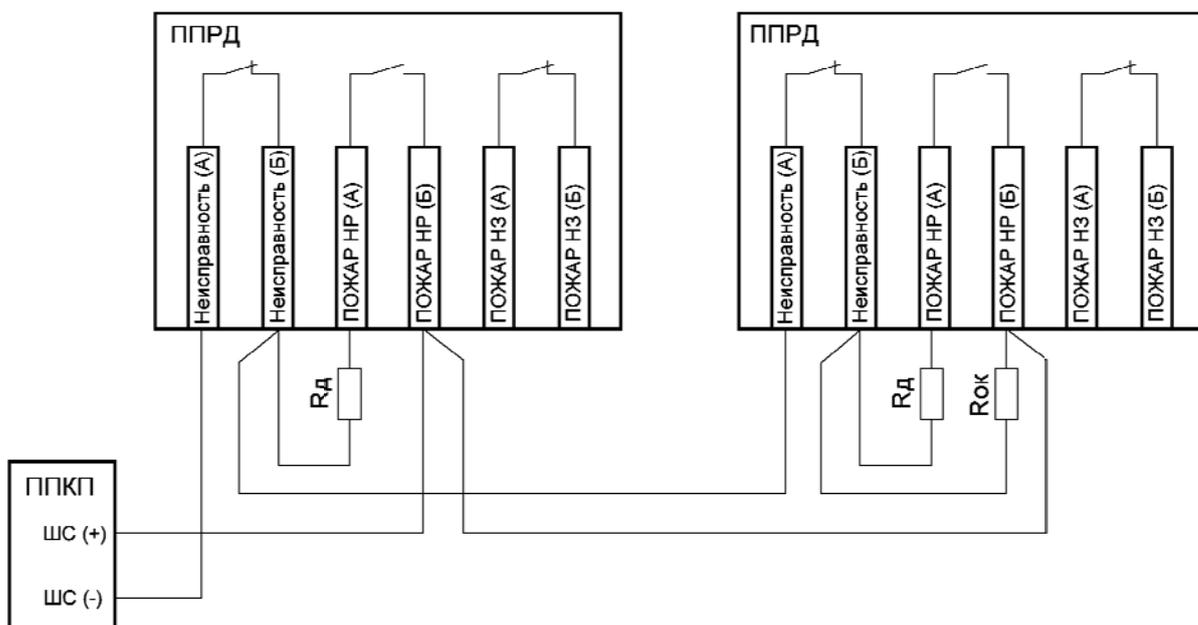
В.4 Подключение извещателей с использованием нормально разомкнутой цепи выхода «Пожар» («ПОЖАР НР») к ШС со знакопеременным напряжением
