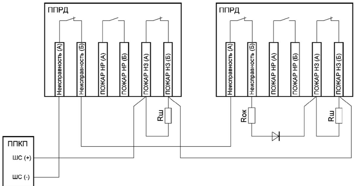
В.3 Подключение извещателей с использованием нормально разомкнутой цепи выхода «Пожар» («ПОЖАР НР») к ШС с однополярным напряжением
