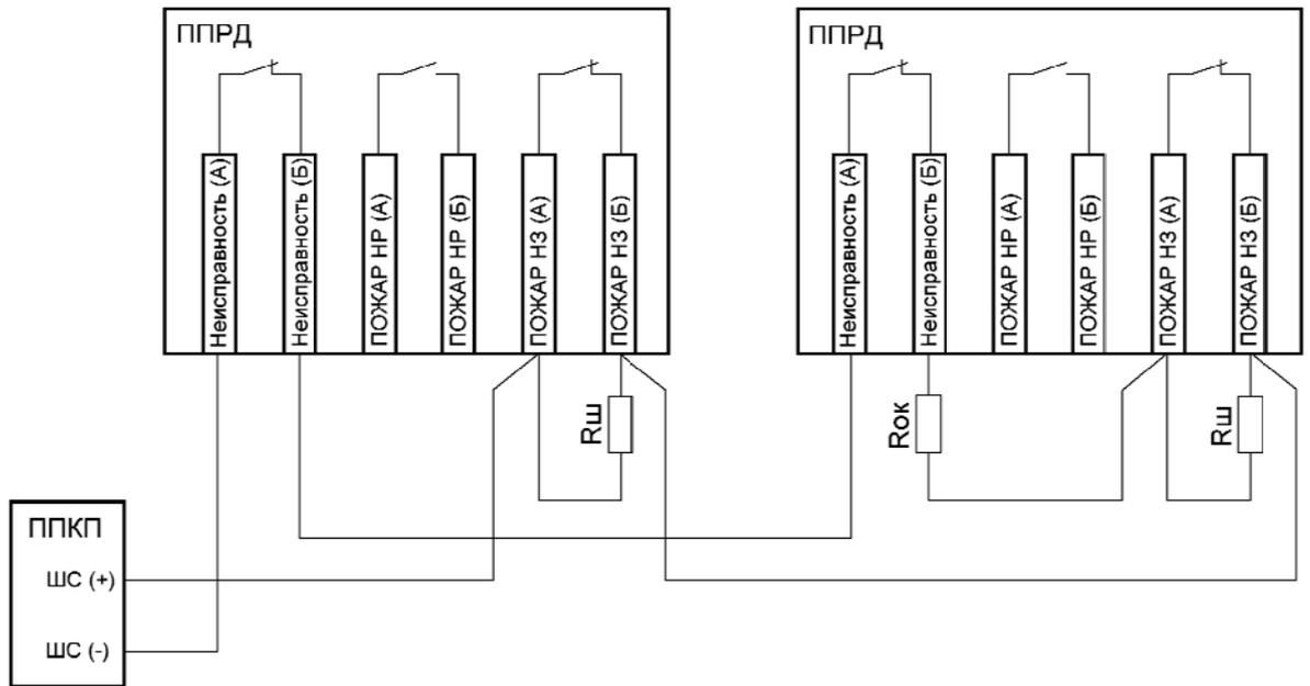
В.2 Подключение извещателей с использованием нормально замкнутой цепи выхода «Пожар» («ПОЖАР НЗ») к ШС со знакопеременным напряжением
