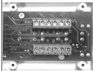
Откройте крышку пульта и подключите, соблюдая цвета, концы кабеля управления к разъему на плате пульта в соответствии со схемой соединений. Закрепите кабель.
