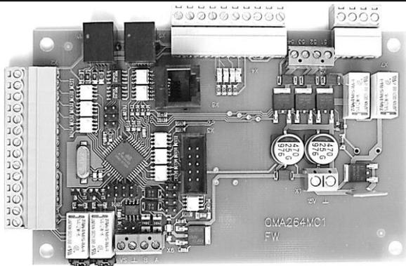
Контроллер управляет работой турникета, получая сигналы от датчиков положения, пульта управления и СКУД. Все входы контроллера защищены от помех оптической развязкой. Выходы - самовосстанавливающейся системой от перегрузки и короткого замыкания за счет контроля напряжения питания.
