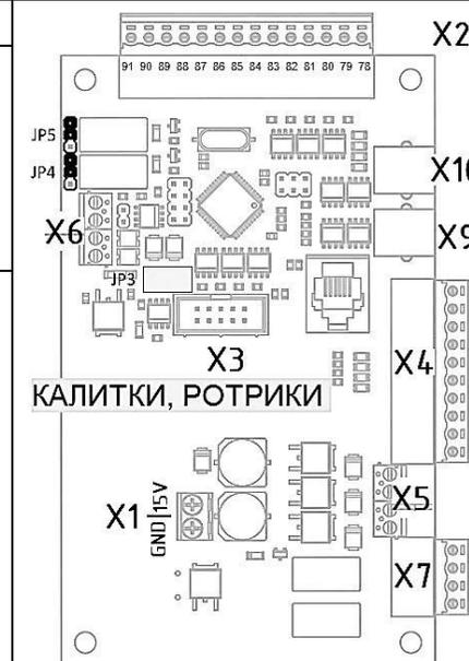
Для входных сигналов контроллер имеет 5 входов с подтягивающим резистором 2 кОм в цепи питания +15В. Управляющим элементом в системе может быть нормально разомкнутый «сухой контакт» реле или транзистор n-p-n структуры с открытым коллектором. Управляющие сигналы должны иметь длительность  $t > 0,2$  с. Транзистор или реле должны обеспечивать ток не менее 10 мА при напряжении 15 В. Управление осуществляется путем замыкания соответствующих контактов на общий провод GND контроллера (контакт 91).
