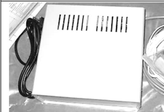
Блок управления ОМА-36.6CU выполнен в виде настольного прибора в пластиковом корпусе. Размер 240x217x95 мм. В корпусе установлен понижающий блок питания, плата контроллера и преобразователь. На задней части корпуса блока находится ввод сетевого кабеля и отверстия для ввода кабеля системы и кабеля управления. На плате установлены колодки для подключения кабелей.
