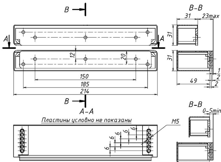
Рисунок 2 – Габаритно-установочные размеры комплекта МК 400S-PS
