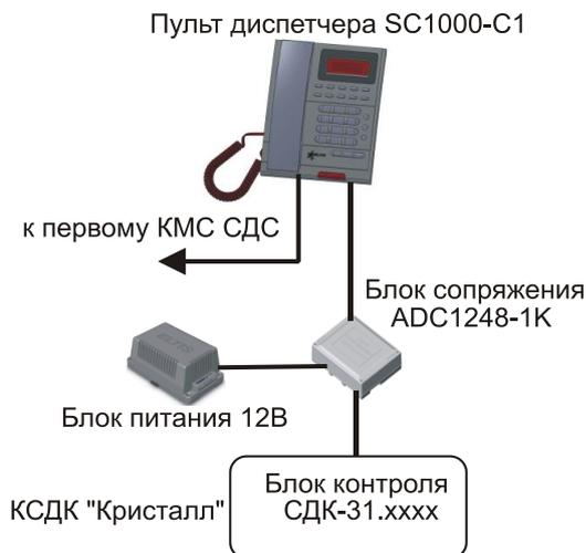
Рис.20 Структурная схема подключения СДС к КСДК «Кристалл»
