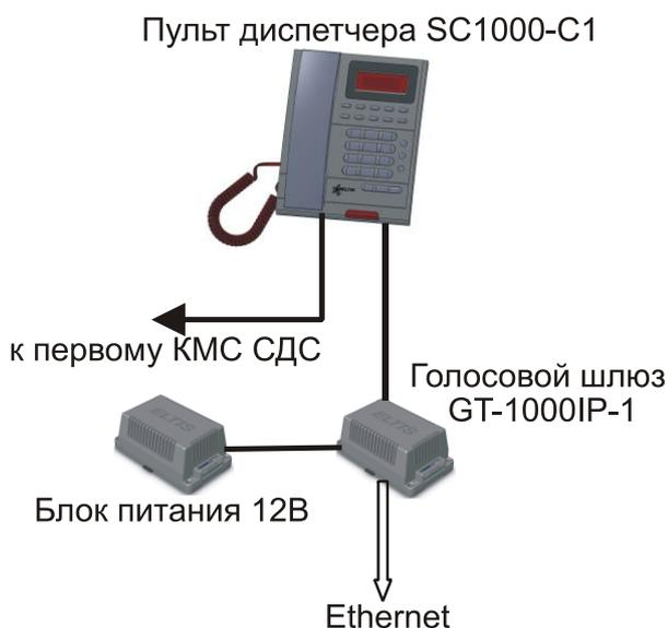
Рис.21 Структурная схема СДС к использованию ГШ GT-1000IP-1
