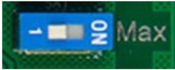
Для включения нижнего диапазона чувствительности устанавливают переключатель поз.1 в левое положение
