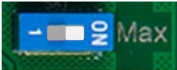
Для включения верхнего диапазона чувствительности устанавливают переключатель поз.1 в правое положение (положение "ON")
