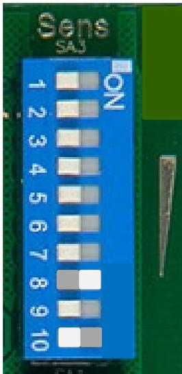
Регулировку необходимой чувствительности внутри диапазона осуществляют установкой одного флажка переключателя регулировки чувствительности поз.2 в правое положение (положение "ON") и установкой всех остальных флажков в левое положение
