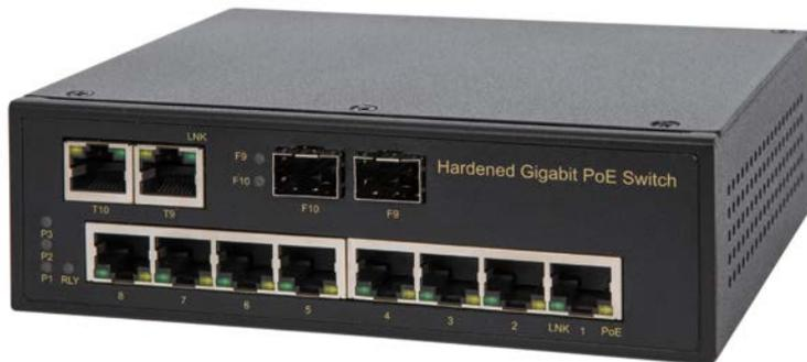
PoE коммутатор NIS-3200-208PSG имеет 8 портов Ethernet 10/100/1000Base-T и два совмещенных гигабитных TP/SFP порта для подключения к магистралам. Магистральные порты могут работать как обычные «медные» со скоростью 10/100/1000M через разъем RJ45 или как оптические порты со скоростью 1000M.
