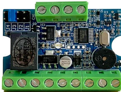
Автономный контроллер ST-SC101 предназначен для построения независимой системы контроля доступа с управлением одной дверью. Этот контроллер оснащается интерфейсом Wiegand или iButton и используется совместно с внешним считывателем. При этом считыватель устанавливается снаружи, а контроллер – внутри защищаемого помещения, за счет чего обеспечивается более высокий уровень безопасности.
