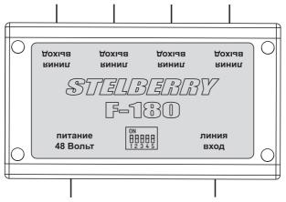
Разъём для подключения блока питания, идущего в комплекте
