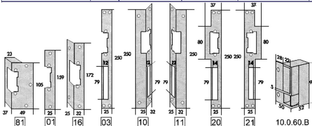
**Типы и габаритные размеры планок. Габариты защелок.**
