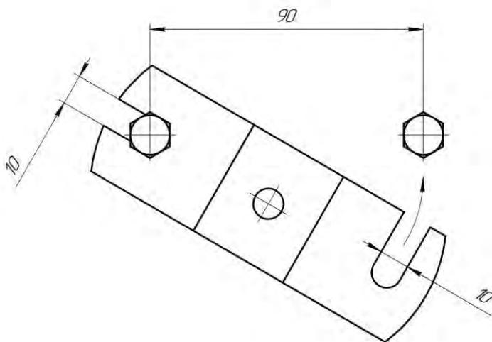
Рисунок 4 – Координаты крепежных отверстий кронштейна модуля
