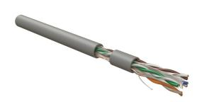
Нуреrline UUTP4R-C6-S23-IN-LSLTX-GY-305 (305 м) Кабель витая пара, неэкранированный U/UTP, категория 6, 4 пары 23 AWG, 4x2x0,55 мм, однопроволочные жилы, нг(A)-LSLTx, внутренний -20°C - +60°C, серый, системная гарантия 25 лет
