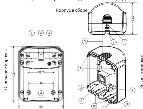
1. Установите извещатель на вертикальную поверхность на высоте 2,1 м и на
