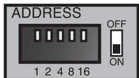
При помощи DIP переключателя на задней панели в двоичном коде следует установить номер блока в системе в соответствии с таблицей.
