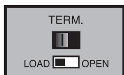
Состояние переключателя TERM (LOAD/OPEN) на задней панели определяется местом блока контроля линий в сетевой цепи устройств системы. Если блок SC-6224 является конечным устройством, то переключатель TERM должен находиться в положении LOAD (см. блок-схему).
