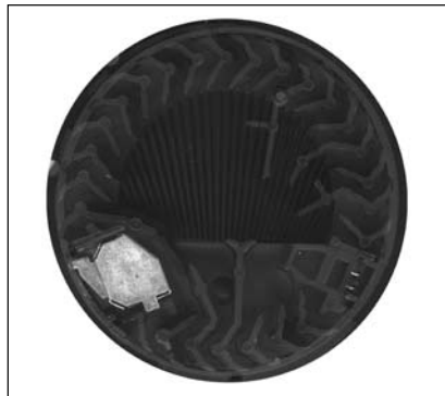
Рис. 6 Дымовая камера извещателей 2112/24, 2151, 2251
