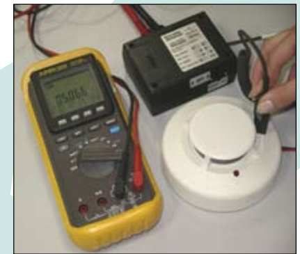
Рис. 8 Измерение фонового сигнала извещателя 2112/24S
