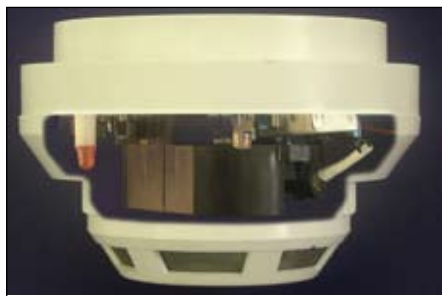
Рис. 3 Конструкция извещателя ДИП-2
