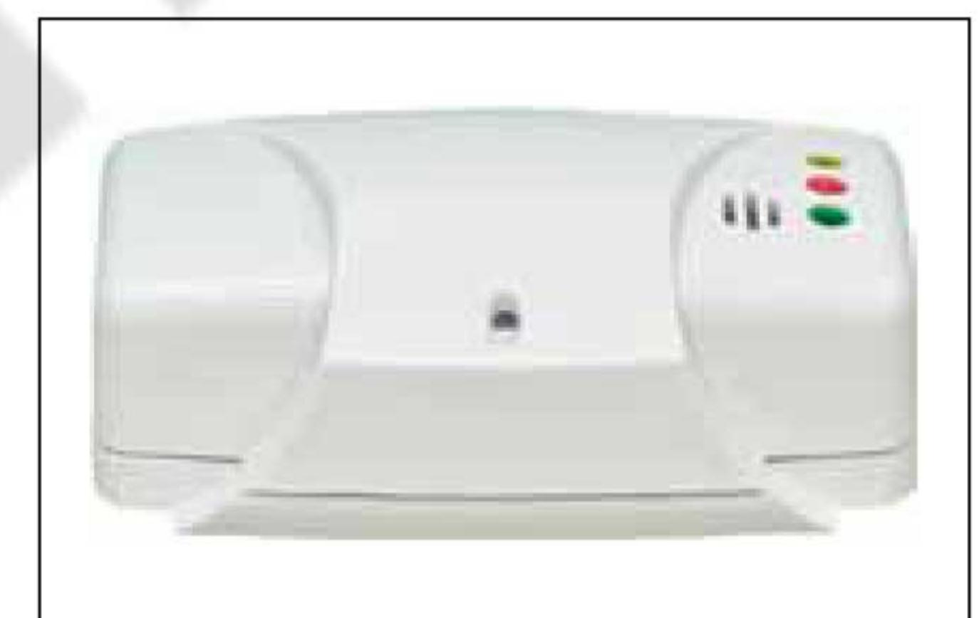
Извещатель «Стекло-4» предназначен для обнаружения разрушения всех видов стекол: обычного, закаленного, узорчатого, армированного, многослойного и защищенного полимерной пленкой (ламинированного), стеклянных пустотелых блоков, а также стандартных одно- и двухкамерных стеклопакетов. Максимальная дальность действия — 6 м. Минимальная контролируемая площадь стекла — 0,1 м<sup>2</sup>. Также извещатель имеет функции контроля напряжения питания, «памяти тревоги», и контроля вскрытия корпуса.
