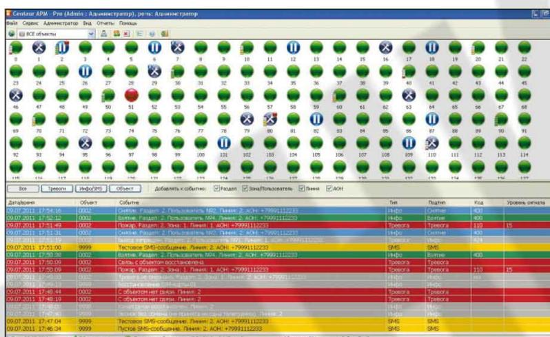
Программный комплекс «Центавр» предназначен для осуществления мониторинга оконечных объектовых систем сигнализации с охранно-пожарными и прочими извещателями (датчиками). Комплекс имеет удобный графический интерфейс пользователя, предоставляющий оператору (дежурному пульта) весь функционал по настройке системы, отслеживанию тревог и реагированию на поступающие от охраняемых объектов события.
