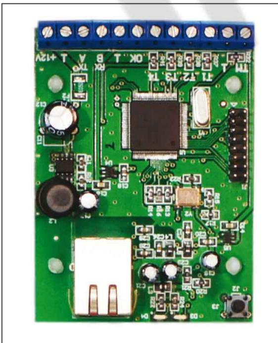
Модуль для работы по каналу Ethernet. Поставляется в виде платы или в пластиковом корпусе для установки на DIN-рейку. Модуль предназначен для передачи извещений на пульт централизованного наблюдения протоколам TCP-TP.
