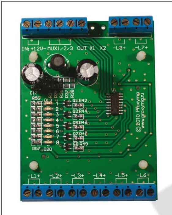
8-зонный расширитель для работы с объектовым приемно-контрольным устройством S632-2GSM обеспечивает увеличение количества подключаемых к устройству шлейфов. Всего при помощи расширителей может обслуживаться до 32 шлейфов датчиков (зон). Поставляется в виде платы или в пластиковом корпусе для установки на DIN-рейку.
