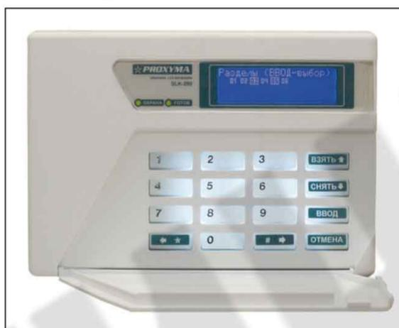
Жидкокристаллическая клавиатура для объектового прибора S632-2GSM. предназначена для использования в составе охранно-пожарных систем. Индицирует статус системы, состояния разделов, зон, напряжение питания, уровень GSM сигнала, напряжение резервного аккумулятора, температуру (если подключен температурный датчик) и многое другое. С клавиатуры возможно управление объектовым прибором, доступны некоторые сервисные функции.
