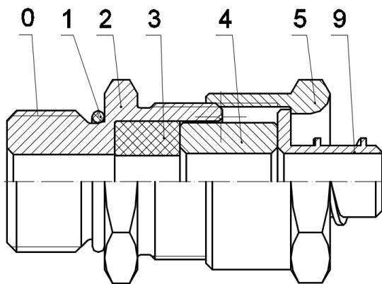
**КВМ** – для монтажа кабеля в металлическом рукаве
