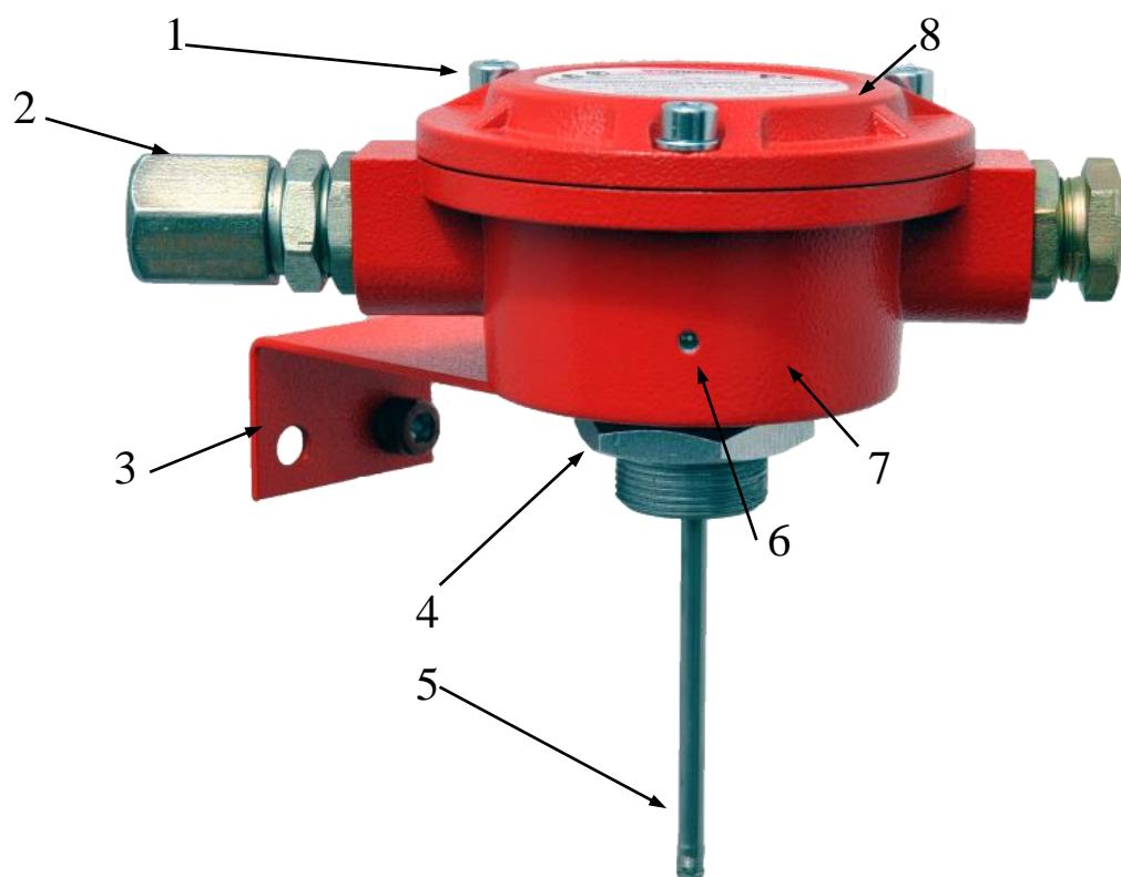
1 – винт M6 с шайбой; 2 – кабельный ввод; 3 – крепежное устройство (К-05); 4 – гайка М30x1,5; 5 – чувствительный элемент; 6 – светодиодный индикатор; 7 – корпус извещателя; 8 – крышка извещателя.
