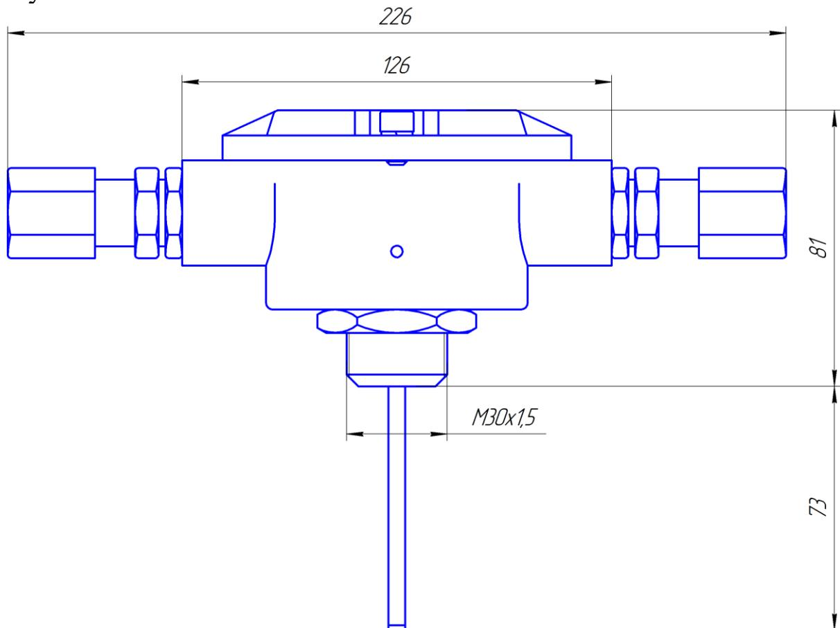
Рис. 1 – Извещатель пожарный тепловой Спектрон-101-Р-Exm-А
